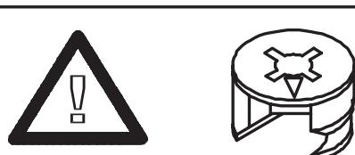
Markierungspfeil muss zur Bohrung in der Bauteilkante zeigen!
